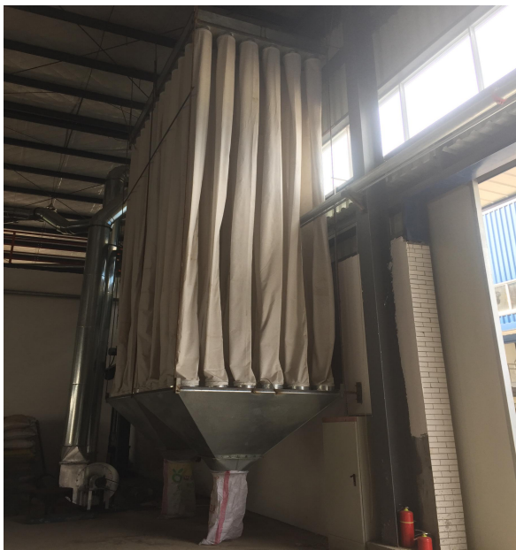
振动筛自带布袋除尘器
